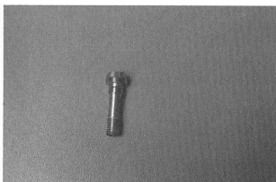
Länge von 2,5 mm auf den Schaftdurchmesser reduzieren c. im Mittelteil nur etwa zehn Gewindegänge stehenlassen, den Rest auf Kerndurchmesser abdrehen
